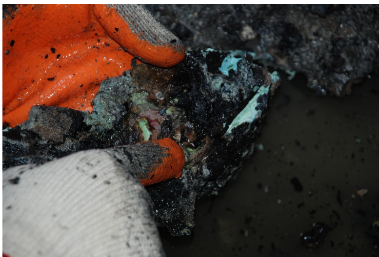
照片 3：起火戶房間 3 東南側塑膠垃圾桶底部殘留菸蒂及紙類碳化物。
