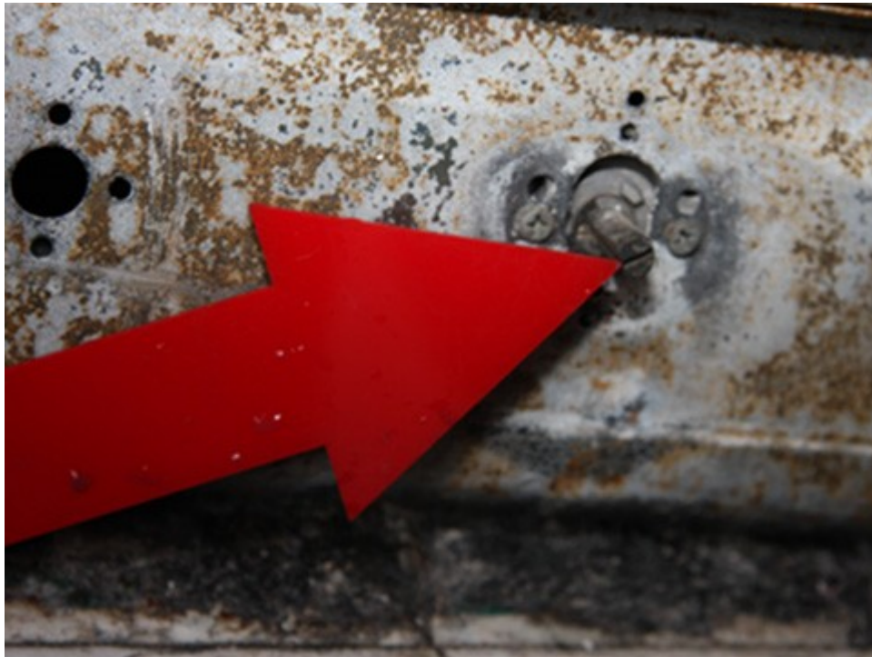
圖 2：勘查起火處附近瓦斯爐東側爐火開關呈使用狀。
