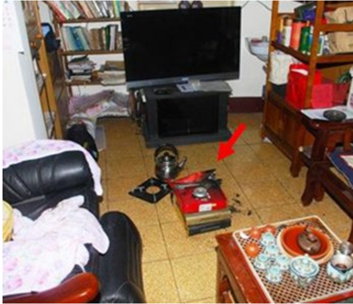
圖 1.客廳地面攜帶式卡式爐受火流燒損，瓦斯瓶罐已受燒爆裂。
