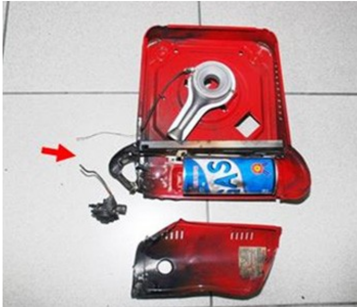
圖 3. 復原攜帶式卡式爐位於瓦斯瓶罐連接處及瓦斯爐減氣閥，均呈現受燒爆裂情形。
