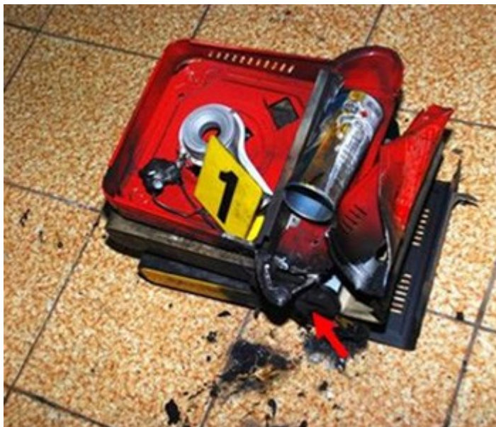
圖 2. 勘查攜帶式卡式爐瓦斯瓶罐接頭處，呈現受燒爆裂情形（如標示）。
