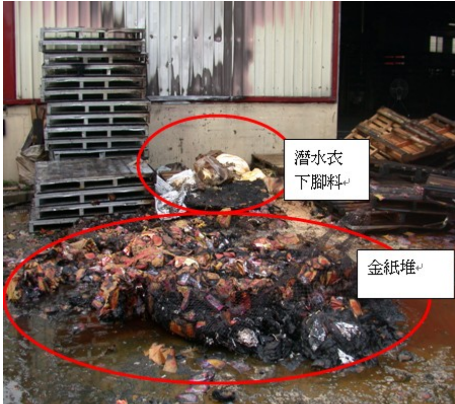
圖2 北側廠房中間部分鐵皮牆壁受燒留有「V」火流痕跡，低點附近散落潛水衣下腳料、大量焚毀金紙堆殘骸、木質棧板
