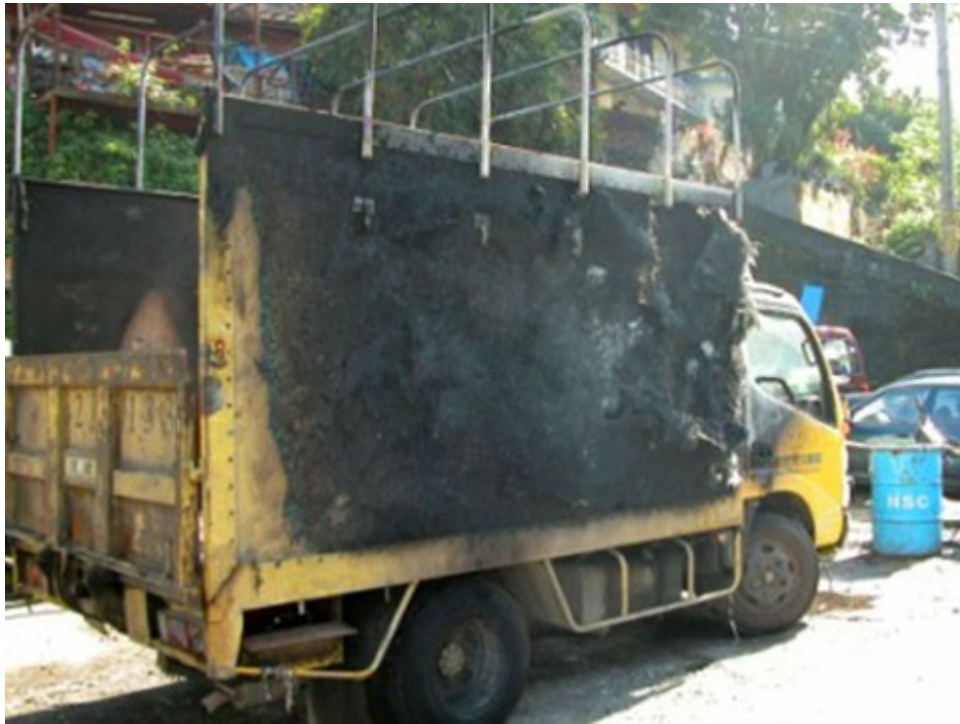
圖 1：半毀車輛右側燒毀嚴重。
