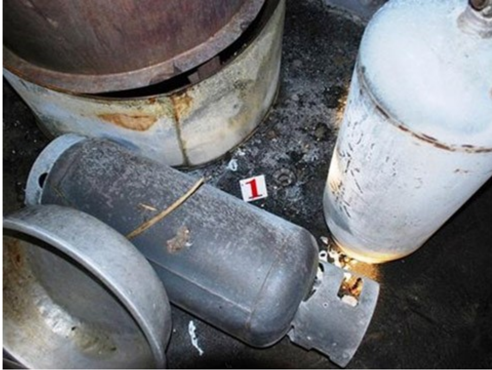
圖 3. 勘查瓦斯爐倒臥地面旁遺留瓦斯開關受火勢燒損掉落於地面
