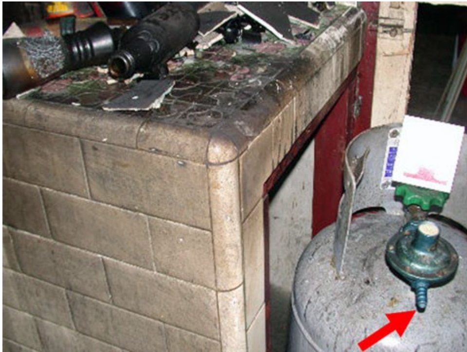
圖 6： 勘查瓦斯桶其導管已燒落，詢問消防搶救人員得知當時開關處，於開啟狀態情形
