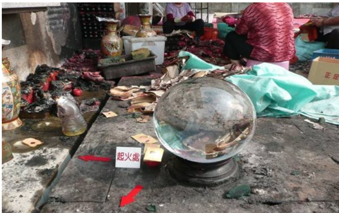
圖8 下午2時50分再次試驗太陽照射水晶球時，陽光聚焦處的金紙不久即冒煙，又聚光部位的夾板台面碳化明顯較深，這顯示起火前聚光部位的夾板面，就已被聚光熱碳化一段時日
