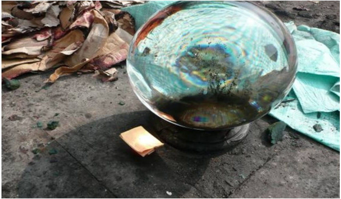
圖 5 經選擇晴天起火時段，再次現場勘查，發現太陽照射火場的水晶球後往後方聚光，其焦點距球體約 10 公分，距地面約 5 公分，這顯示地面的聚光部位溫度非常高
