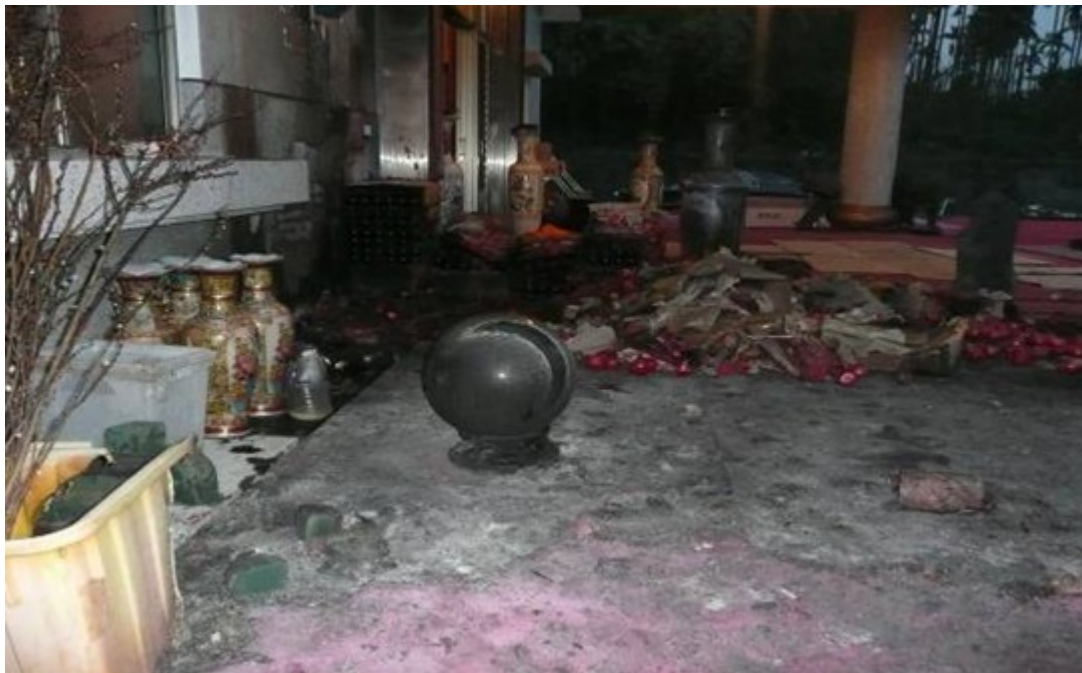
圖4 觀察門亭北側木台面，於地毯燃燒範圍內的北側有1顆直徑36公分的水晶球，此水晶球顯得很突兀，因勘查時太陽被雲遮住，無法看出太陽照射到水晶球後光的變化
