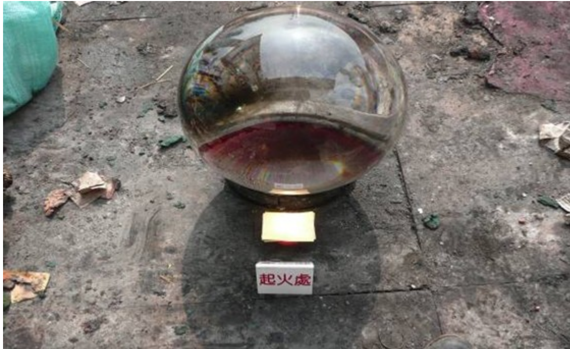
圖7 水晶球是兩個多月前自屋內搬出，就放置在被燒位置。房屋是坐東北朝西南，水晶球位置在門亭北側，所以日間約下午2時以前，太陽被房屋擋住照不到水晶球，這顯示火警時太陽才照到水晶球不久
