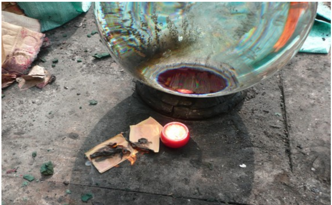
圖 6 經使用金紙靠進聚光位置測試，約 10 秒鐘聚光部位的金紙就起無燄燃燒，冷熱空氣開始對流，金紙被對流（風一張張吹起，突然在 1 分鐘內，被吹起金紙即起火燃燒
