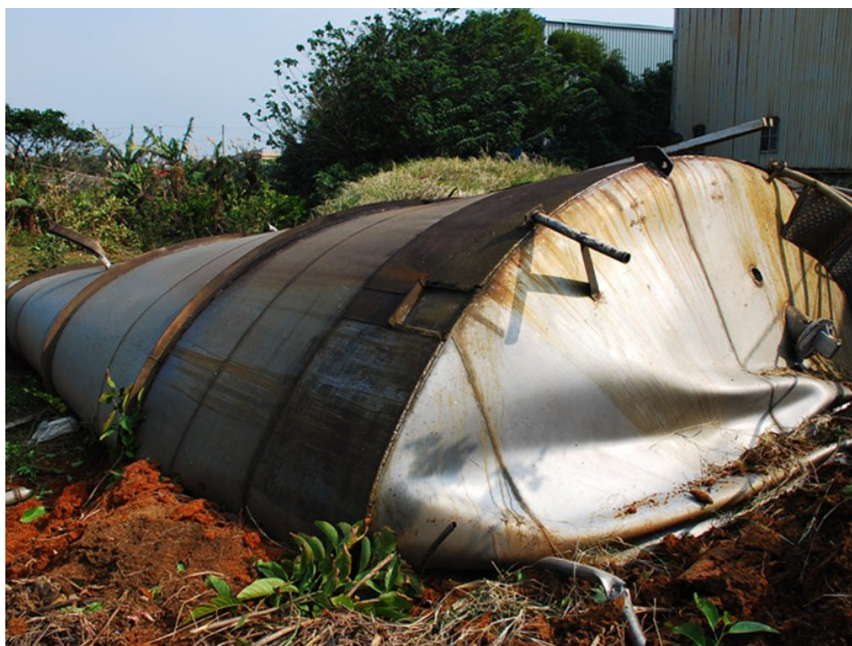
圖 4. 甲酸儲槽炸飛至 300 公尺外
