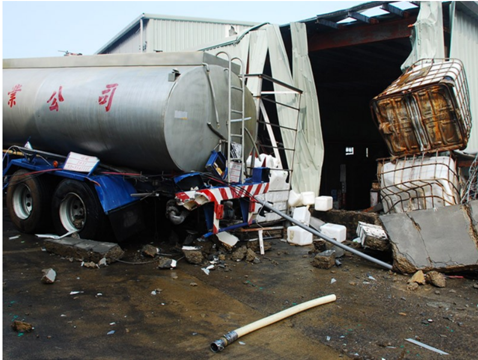
圖 2. 槽車處之管路有斷裂情形
