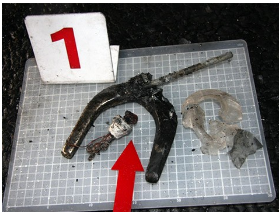
圖 3：清理起火戶，於實木茶几附近下方地面發現燒損嚴重虹吸式咖啡壺、酒精燈玻璃瓶碎片、酒精燈燈芯等煮食咖啡器具
