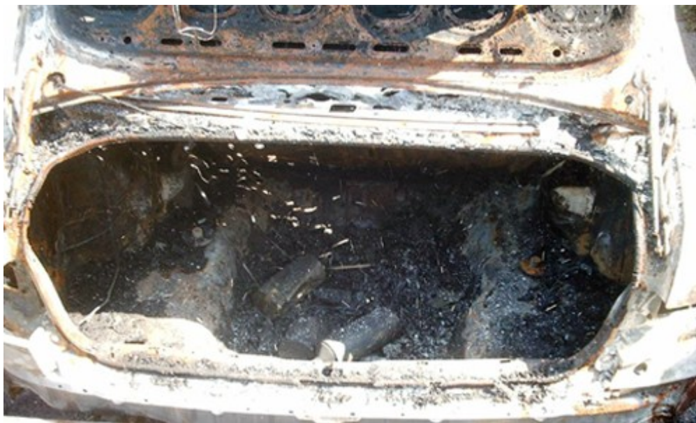
圖 2 後行李箱燒毀嚴重，內有 2 罐備用汽油
