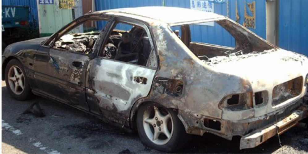
圖 1 路邊起火車輛的後行李箱燒毀嚴重
