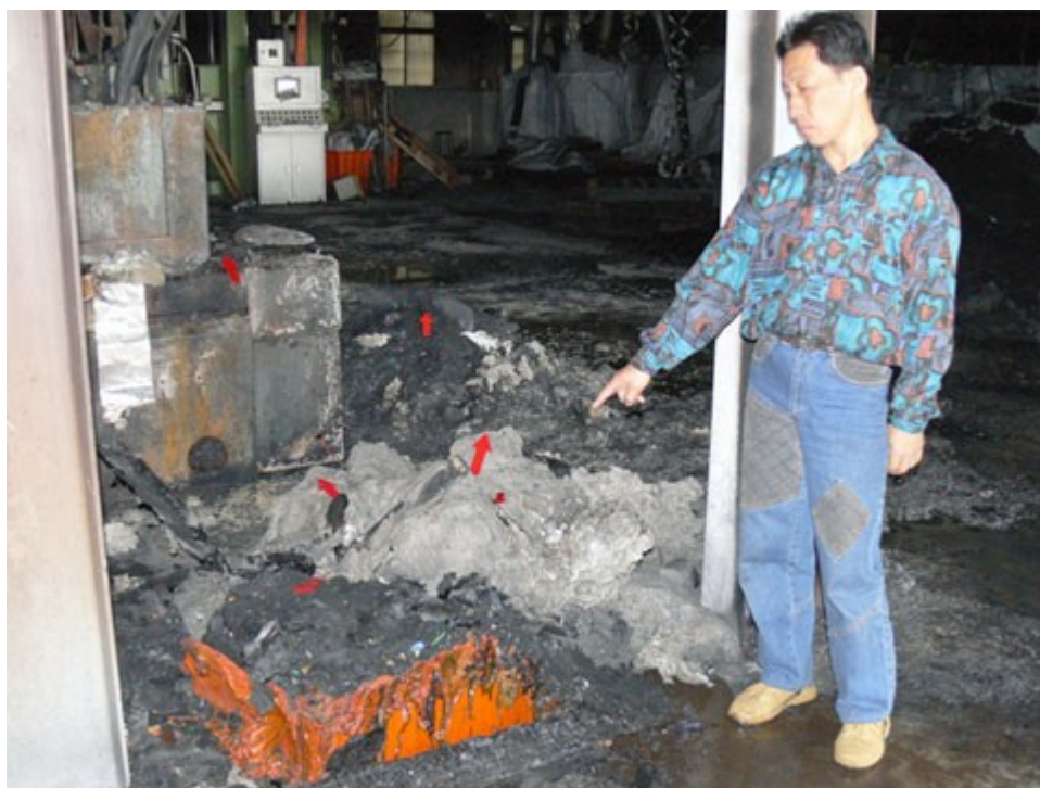
圖 3：橘色塑膠桶燒毀，其內裝塑膠粒結塊物嚴重碳化。
