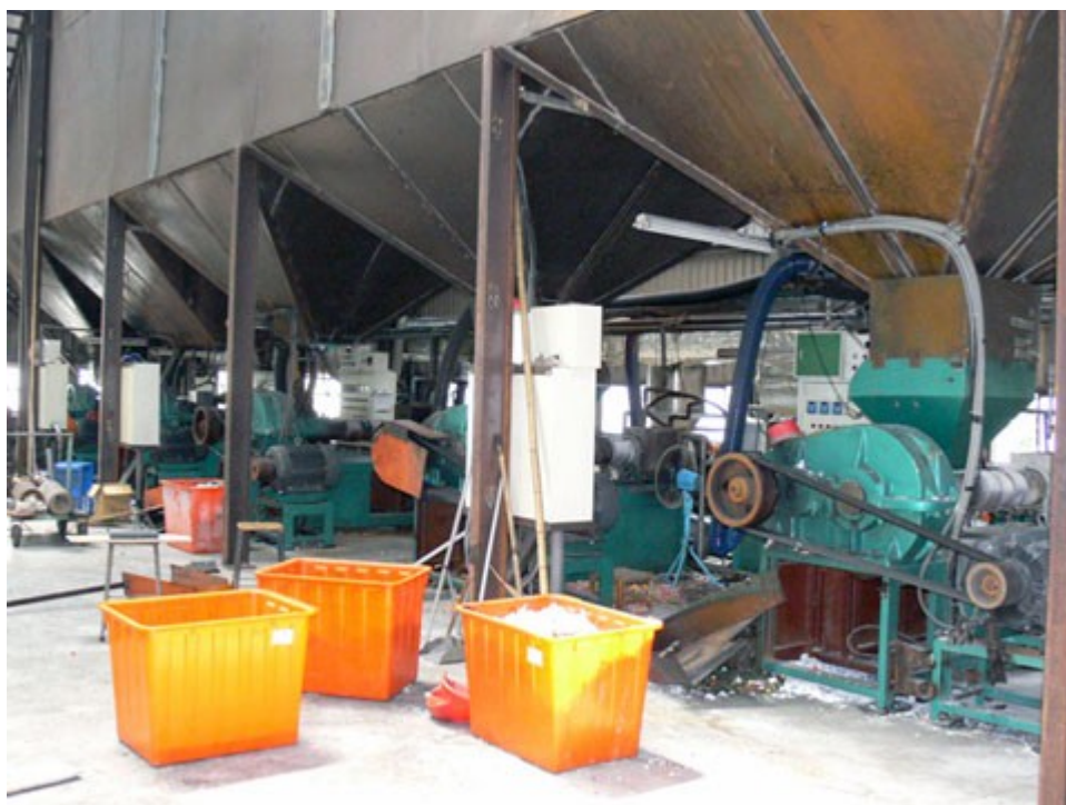
圖 2：員工將結塊物從壓出機舀起放置在橘色塑膠桶內並澆冷水冷卻結塊物。
