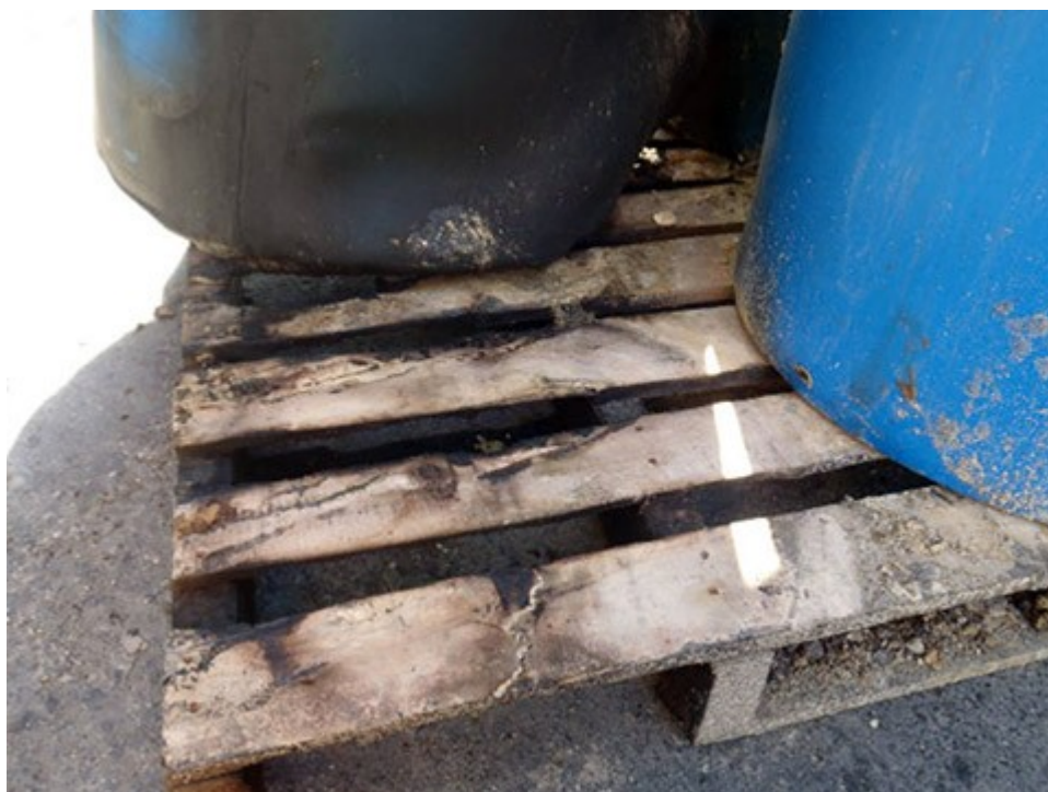
圖 3：含油白土塑膠桶底部棧板燒損較為嚴重
