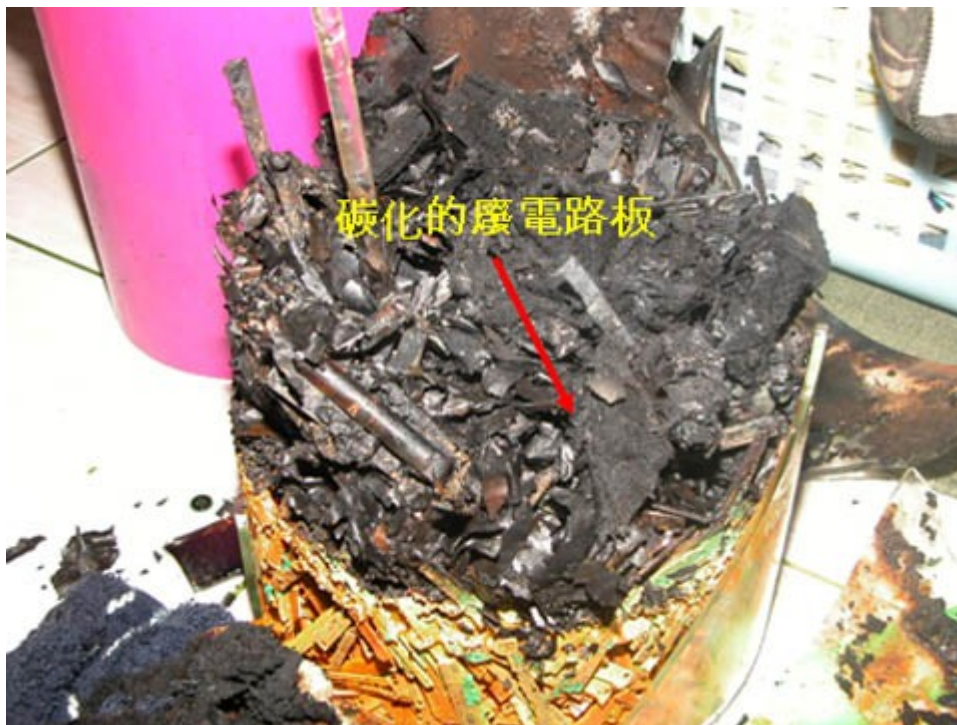
圖 3：廢電路板及滅火用抹布碳化。
