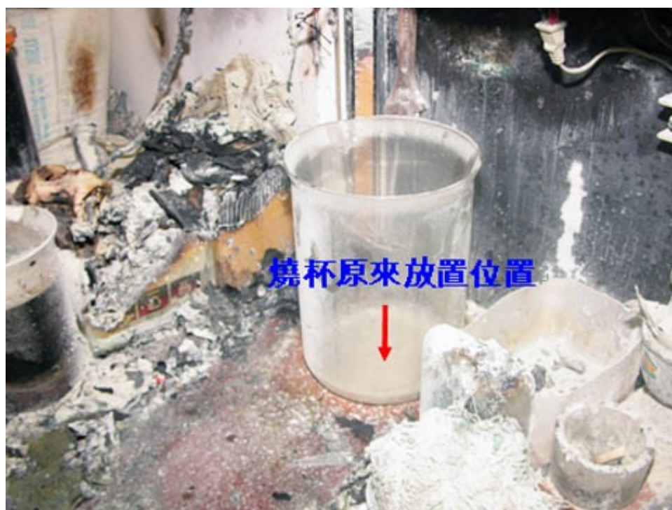
圖 4：燒杯位置復原，燒杯上方牆面熏黑，燒杯左側紙箱上方燒失。
