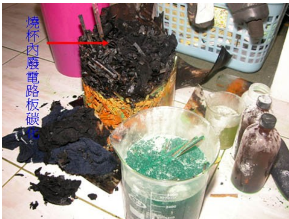
圖 2：搬運中破裂的燒杯受燒情形，燒杯內廢電路板碳化，燒杯外殼未燻黑。
