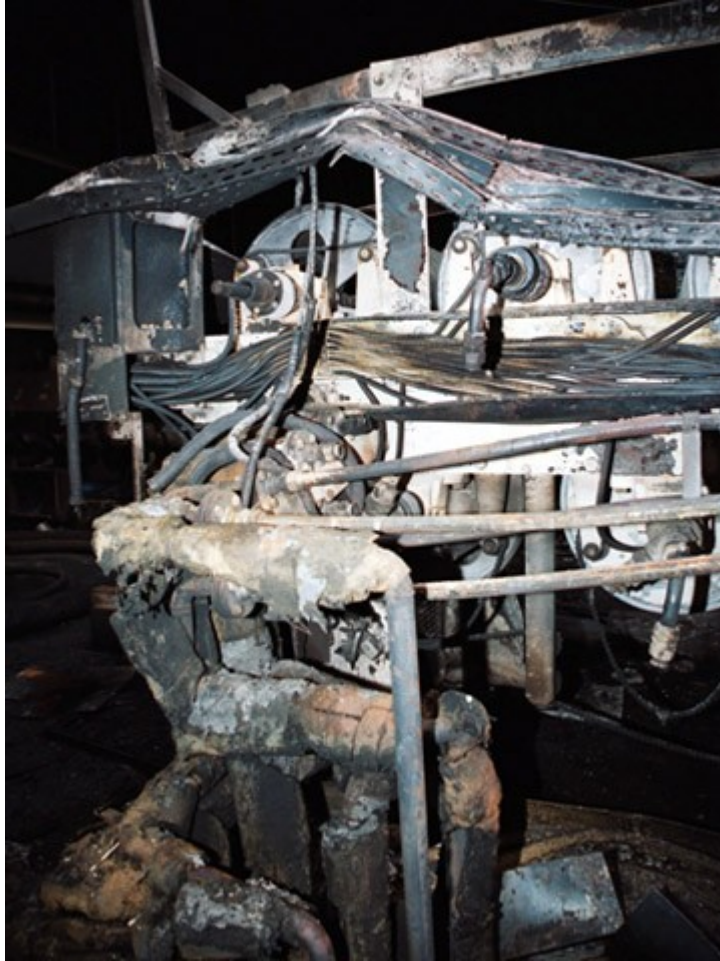
圖 3. 縱向延伸機第 1 輪接頭脫
