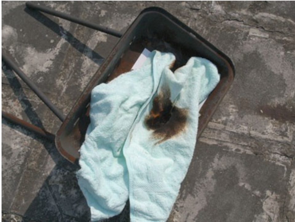
圖 7： 點燃燻香錐放置純棉毛巾上方 12 分鐘後起火持續燃燒。
