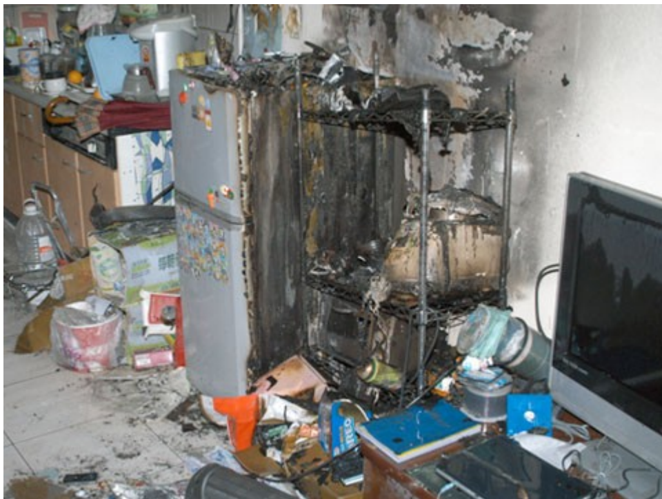
圖 4：冰箱南側面燃燒後情形。
