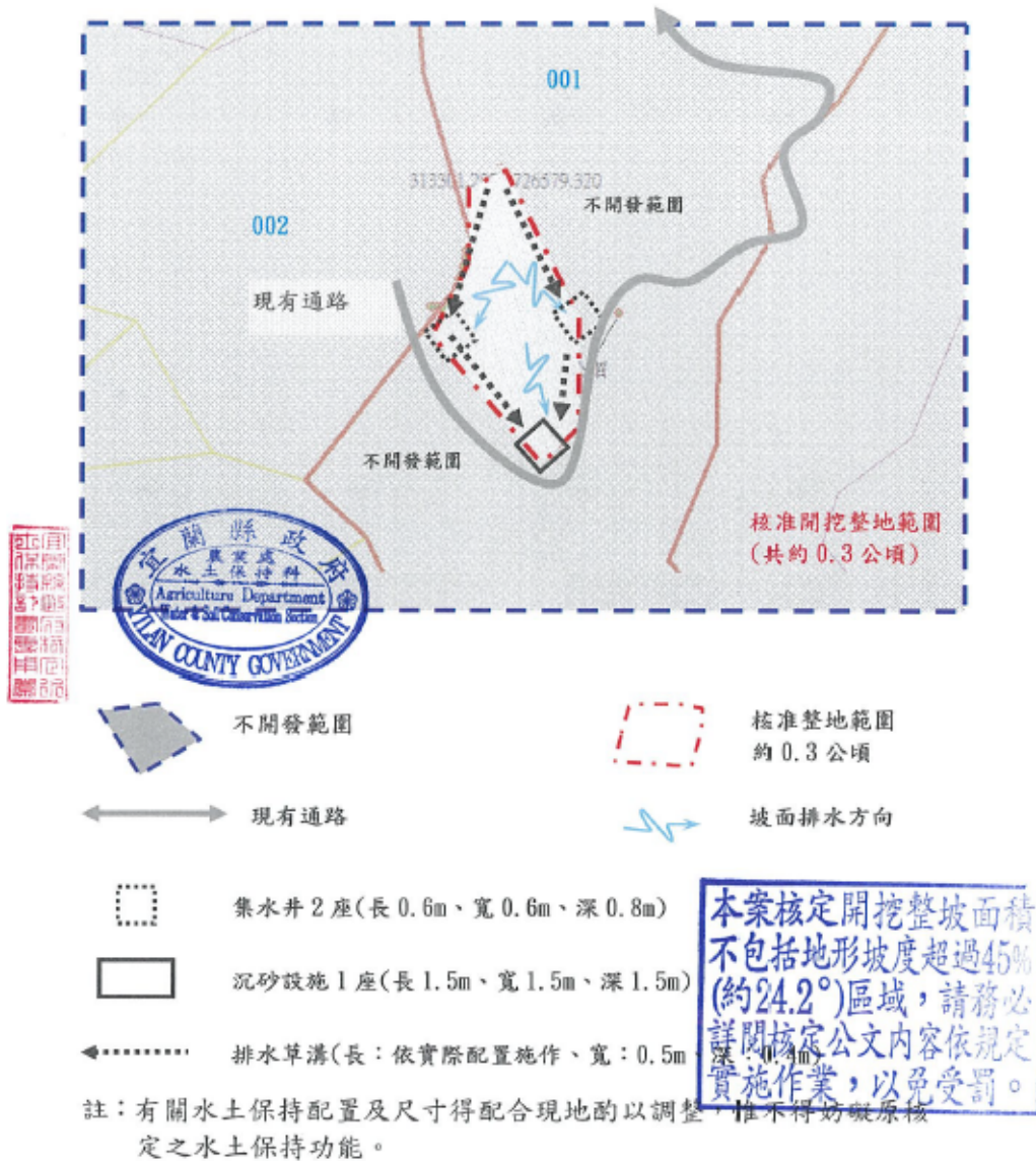
三星鄉長埤湖段 001 地號簡易水土保持設施平面配置示意圖
