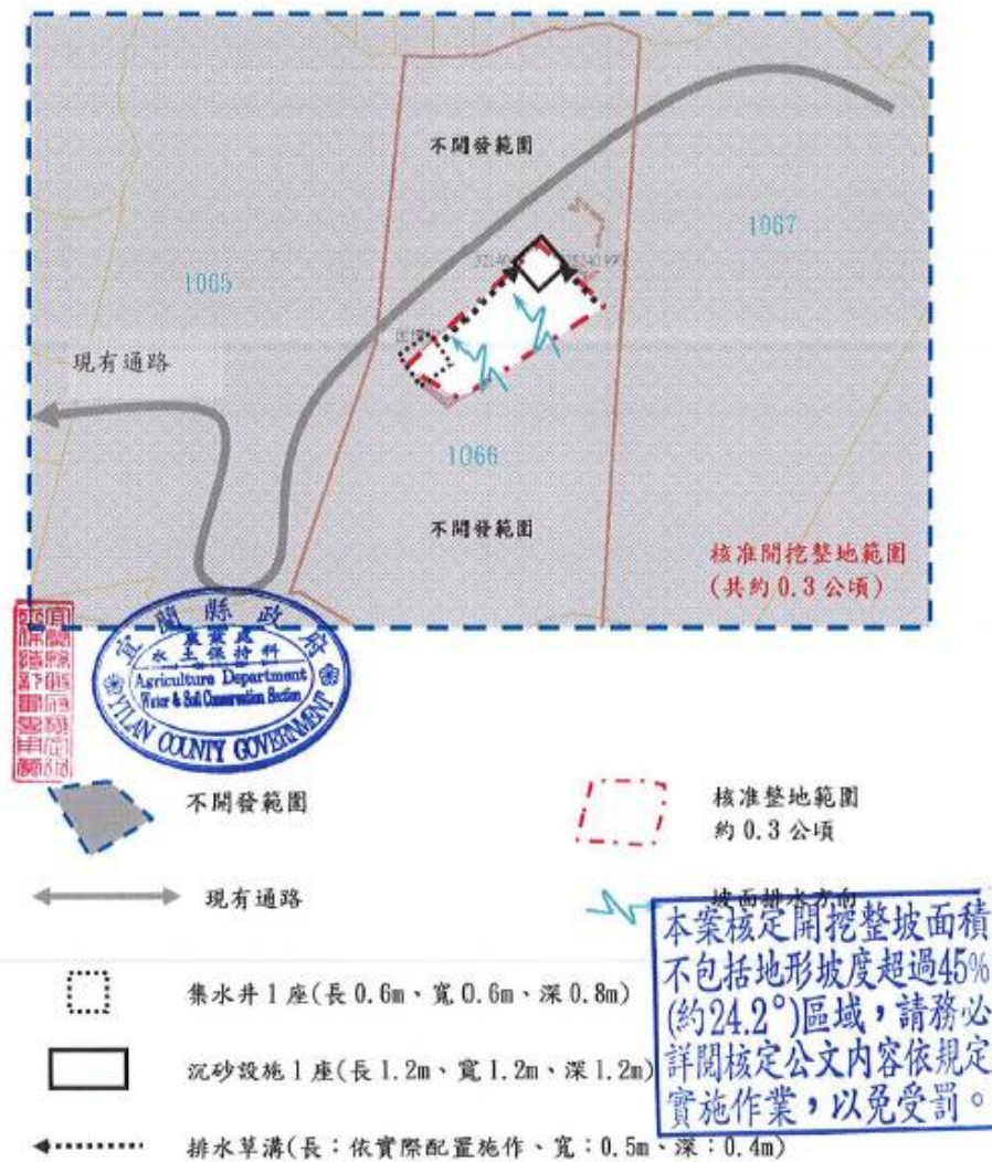
三星鄉大隱一段 1066 地號簡易水土保持設施平面配置示意圖
