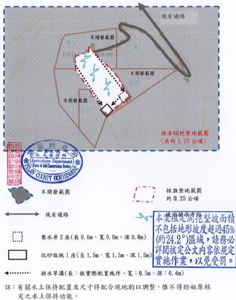
三星鄉長埤湖段 9-1、9-2 及 9-3 地號簡易水土保持設施平面配置示意圖
