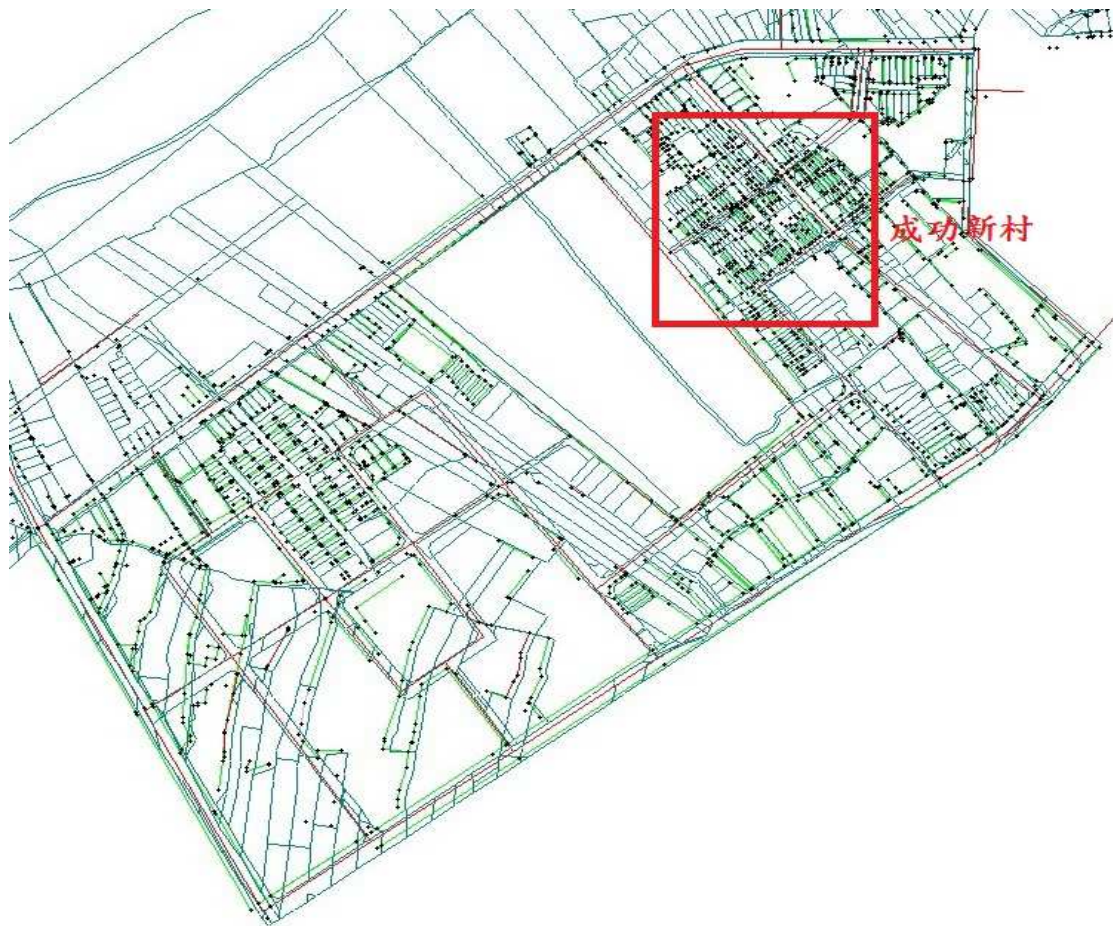
圖 4-8 現況測量完成點位分布圖 (+點為所測得之現況點)
