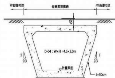
➤ 斷面C-C：新設箱涵斷面
