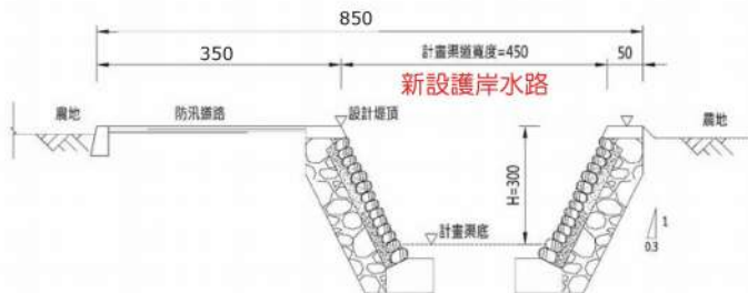
➤ 斷面B-B：新設護岸水路斷面
