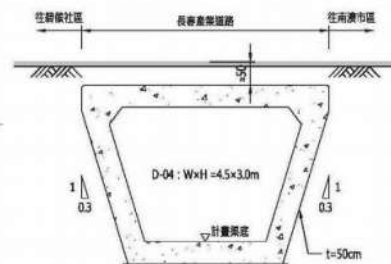
➤ 斷面C-C：新設箱涵斷面
