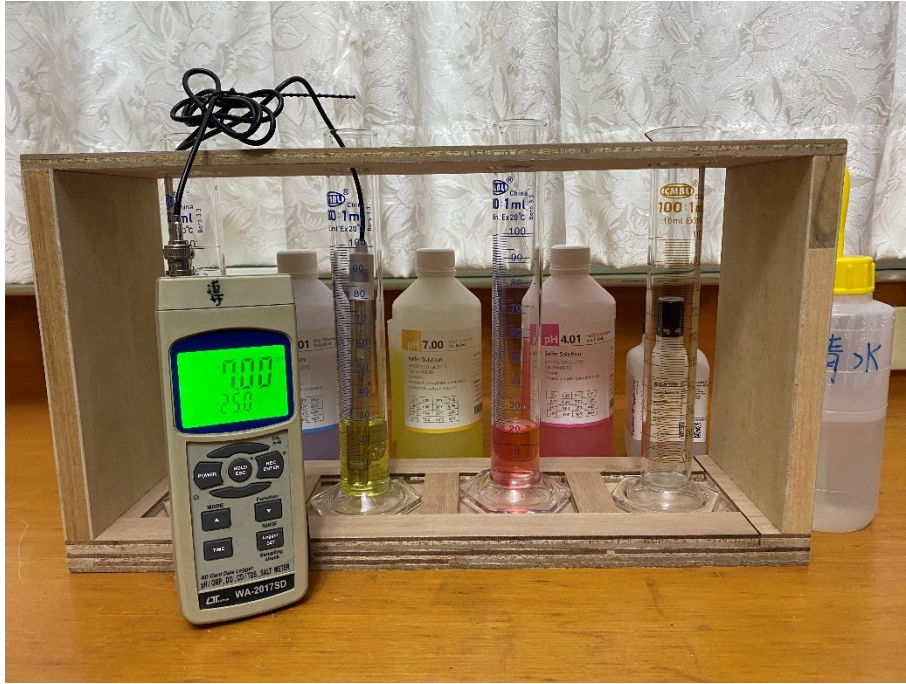
圖 2-7 酸鹼值和導電度的校正
