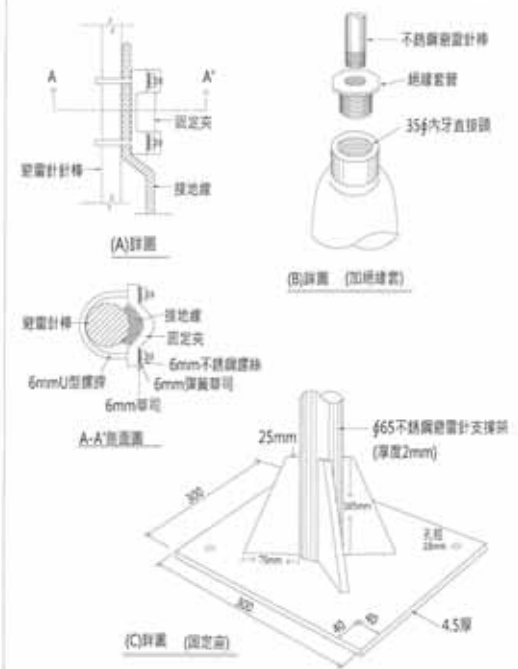
支撐架裝置示意圖(單位:mm)
