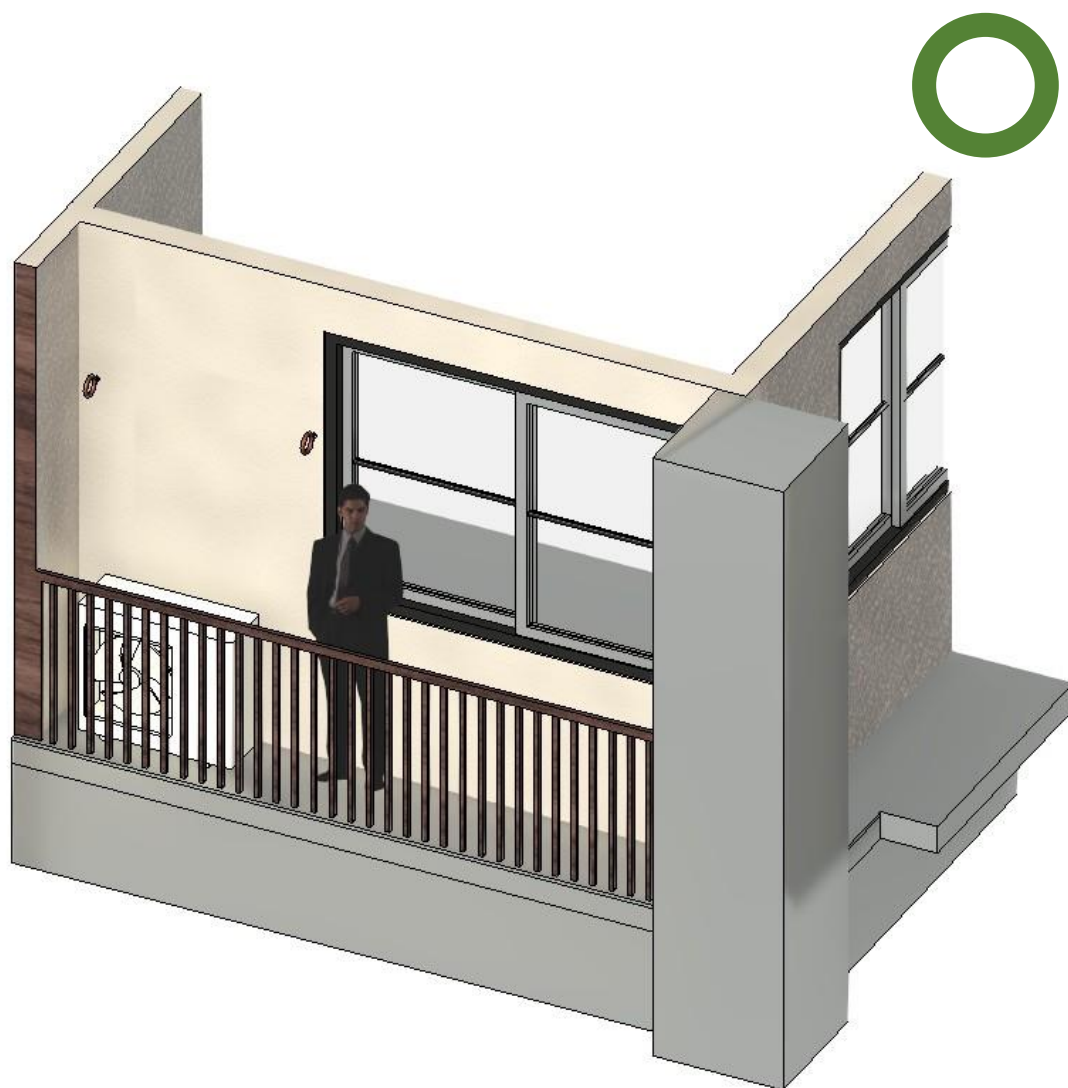
圖 2-2、露樑設置室外機範例
