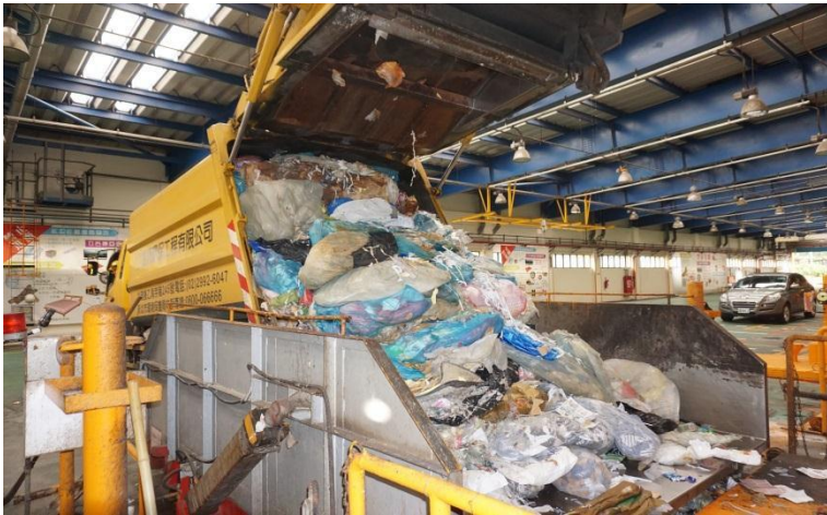
將垃圾車駛入廠區內倒出垃圾
