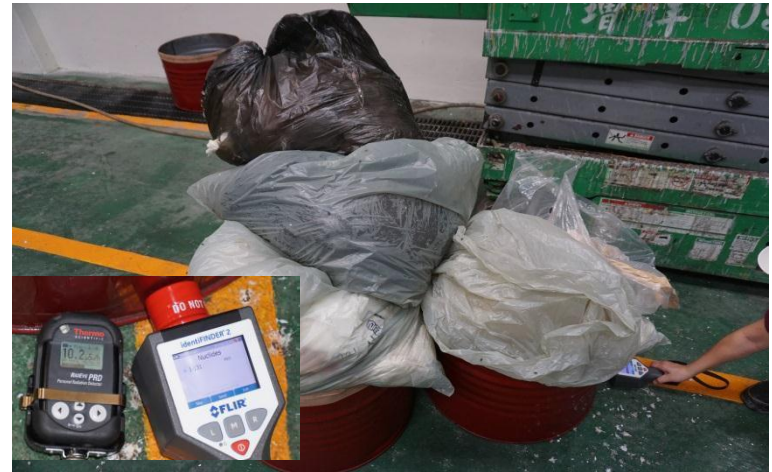
輻射異常物集中放入鐵桶內隔離管制
