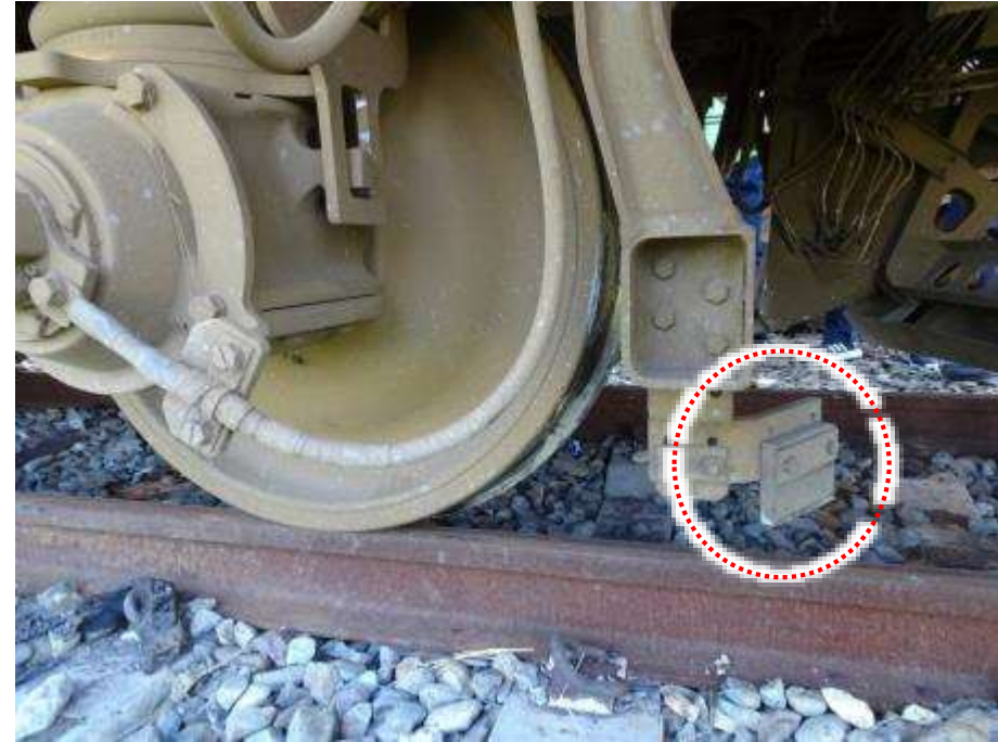
第1節車廂前方轉向架 輔助排障器
