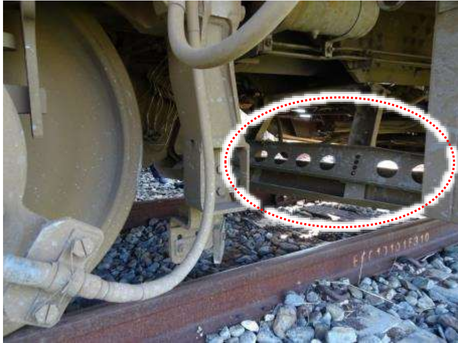
第1節車廂前方轉向架 主排障器
