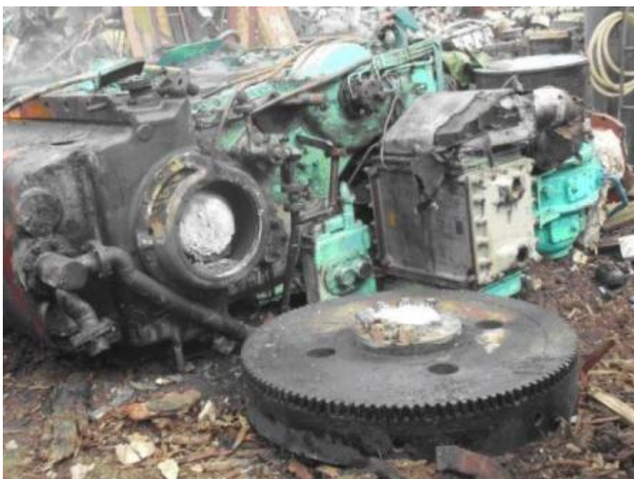
主機引擎曲軸切斷後
