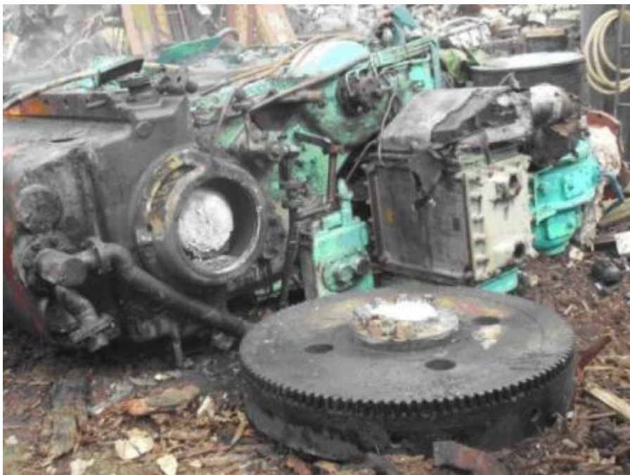
主機引擎曲軸切斷後
